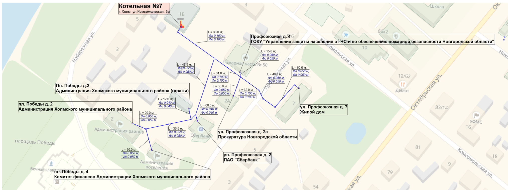
Рисунок 1.5. - Схема тепловых сетей Котельной № 7, г. Холм, ул. Комсомольская, д. 3а
