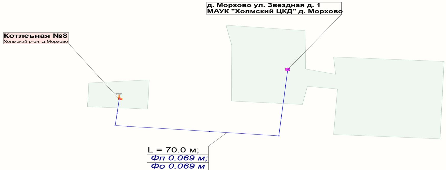
**Рисунок 1.1** Схема тепловых сетей котельной №8, д. Морхово
