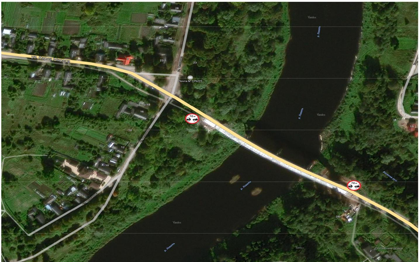
Схема расстановки дорожных знаков 3.3. «Движение грузовых автомобилей запрещено» по ул. Панфиловцев на участке от ул. Свердлова до ул. Володарского
