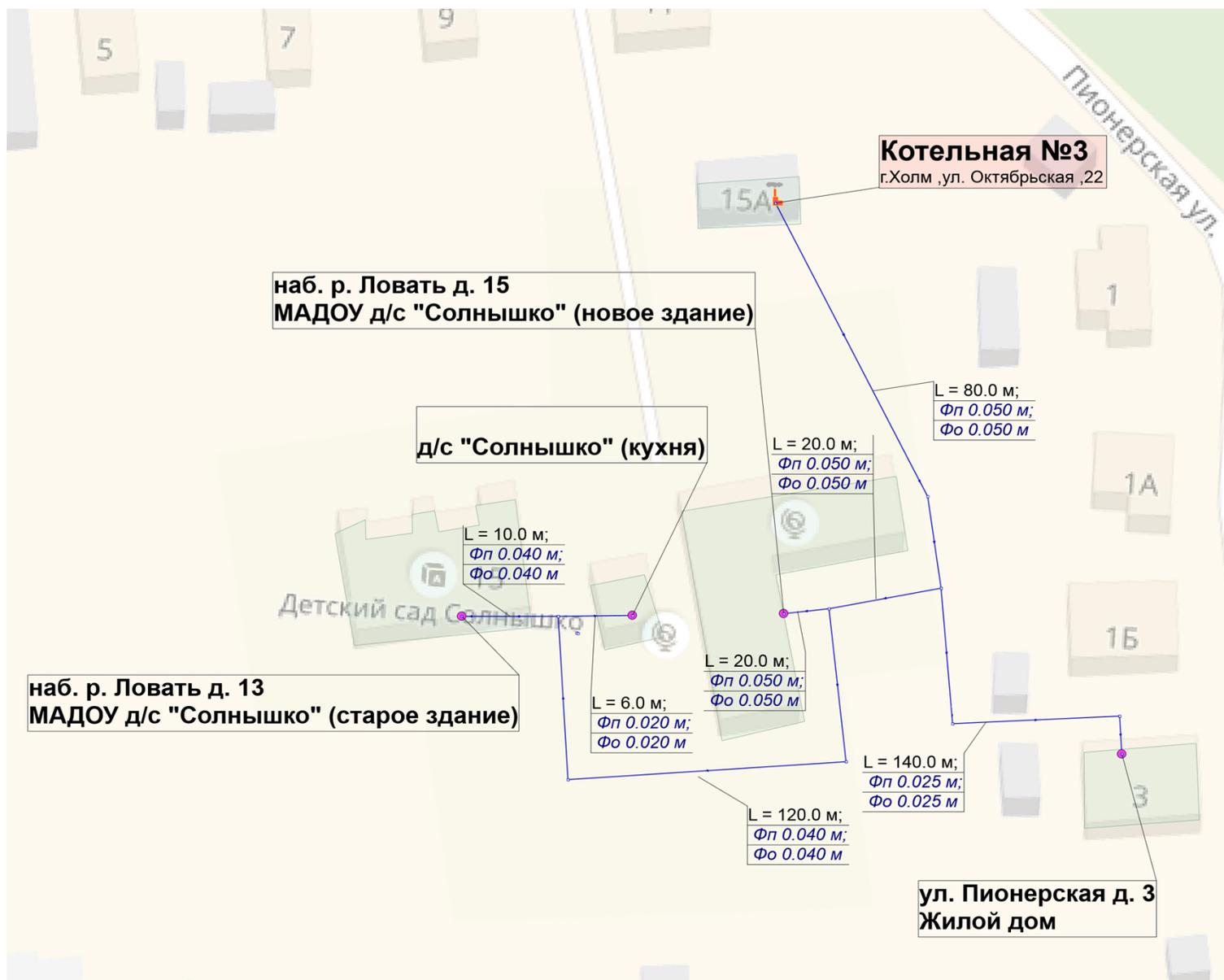
Рисунок 1.3. - Схема тепловых сетей Котельной № 3, г. Холм, ул. Октябрьская, д. 22
