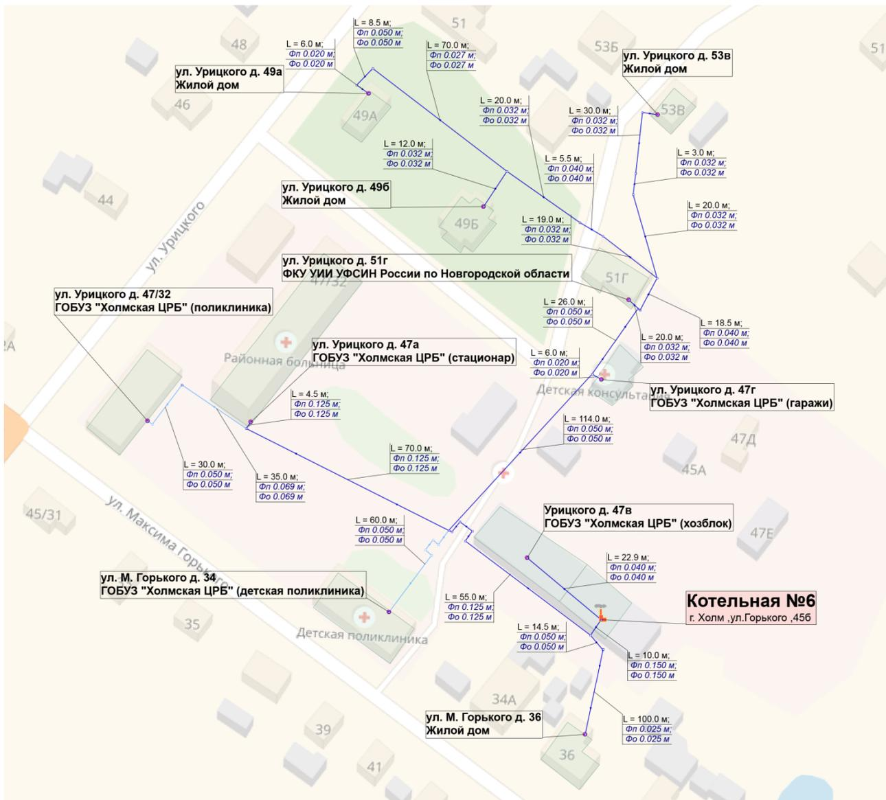
Рисунок 1.4. - Схема тепловых сетей Котельной № 6, г. Холм, ул. Горького, д. 456
