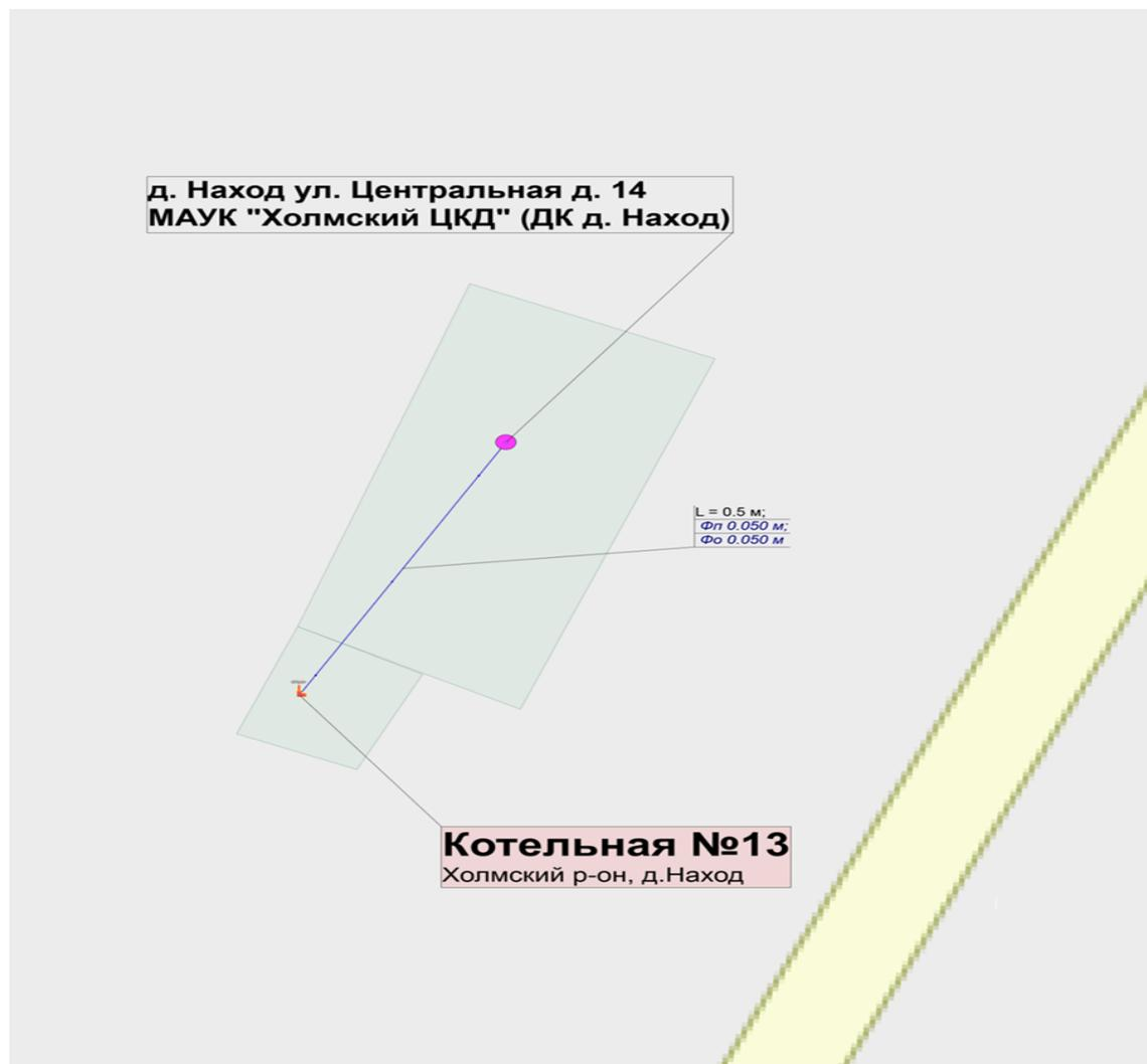
Рисунок 1.2 Схема тепловых сетей котельной №13
