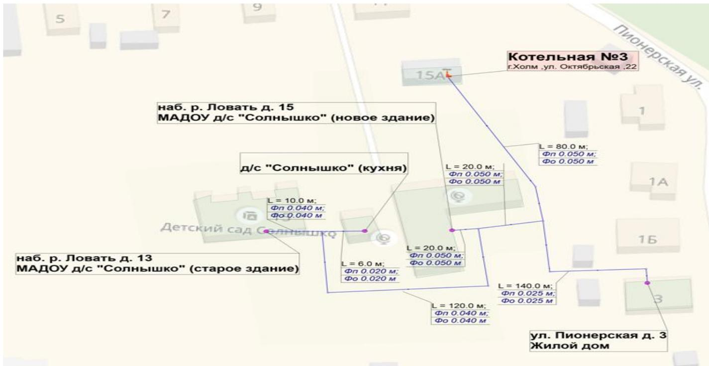
Рисунок 1.3. - Схема тепловых сетей Котельной № 3, г. Холм, ул. Октябрьская, д. 22
