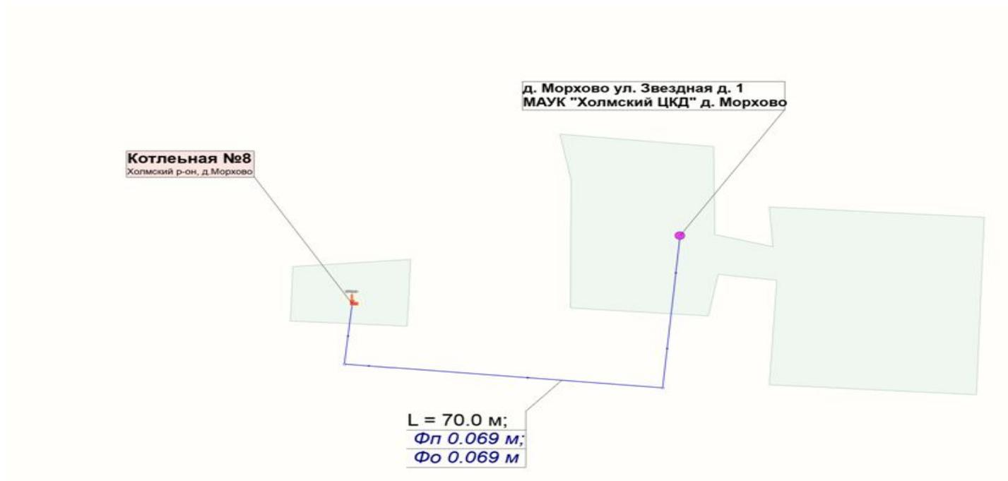
Рисунок 1.1.1 Схема тепловых сетей котельной №8, д. Морхово
