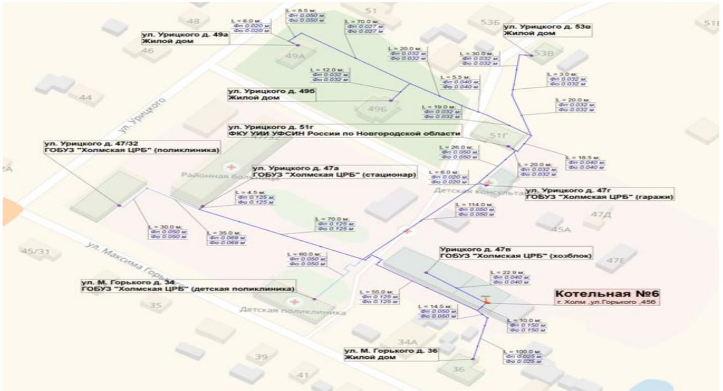
Рисунок 1.4. - Схема тепловых сетей Котельной № 6, г. Холм, ул. Горького, д. 45б
