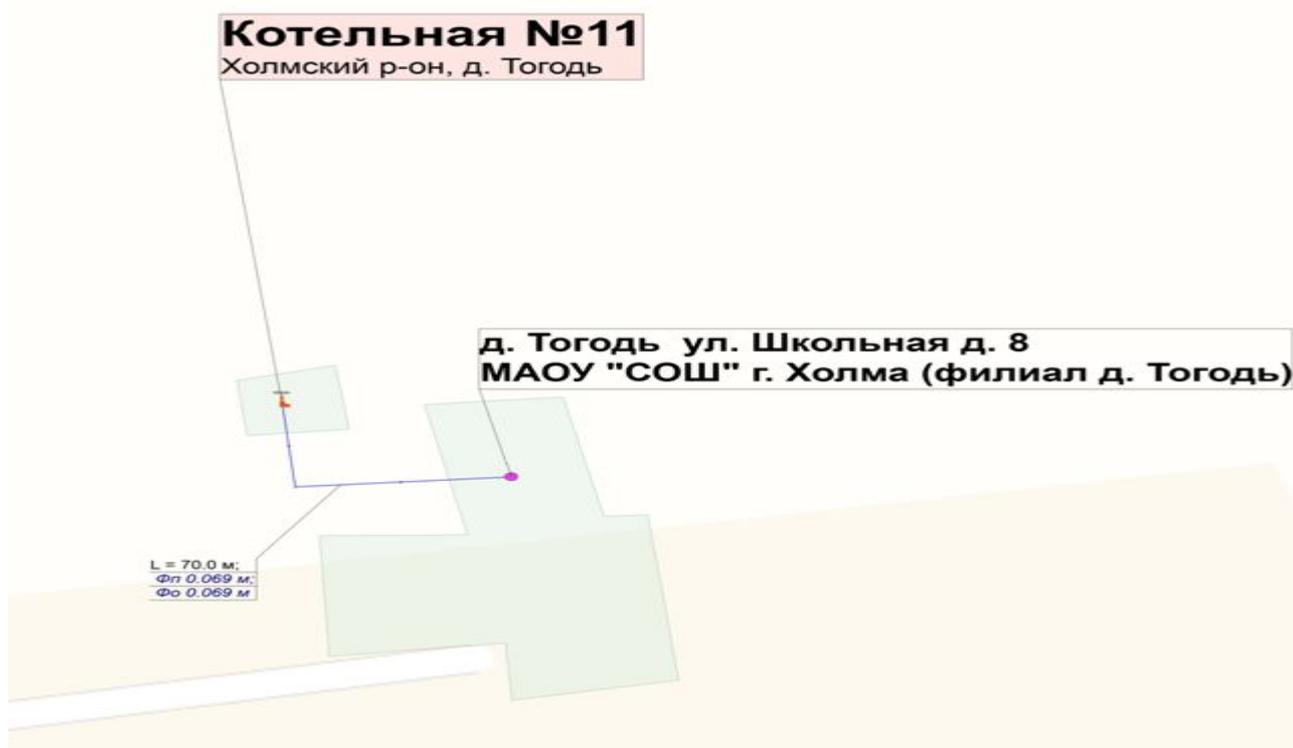
Рисунок 1.1 Схема тепловых сетей котельной №11
