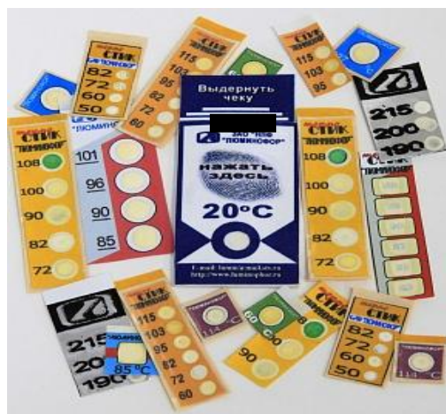
Рисунок 13. Примеры термоиндикаторных наклеек различных производителей
