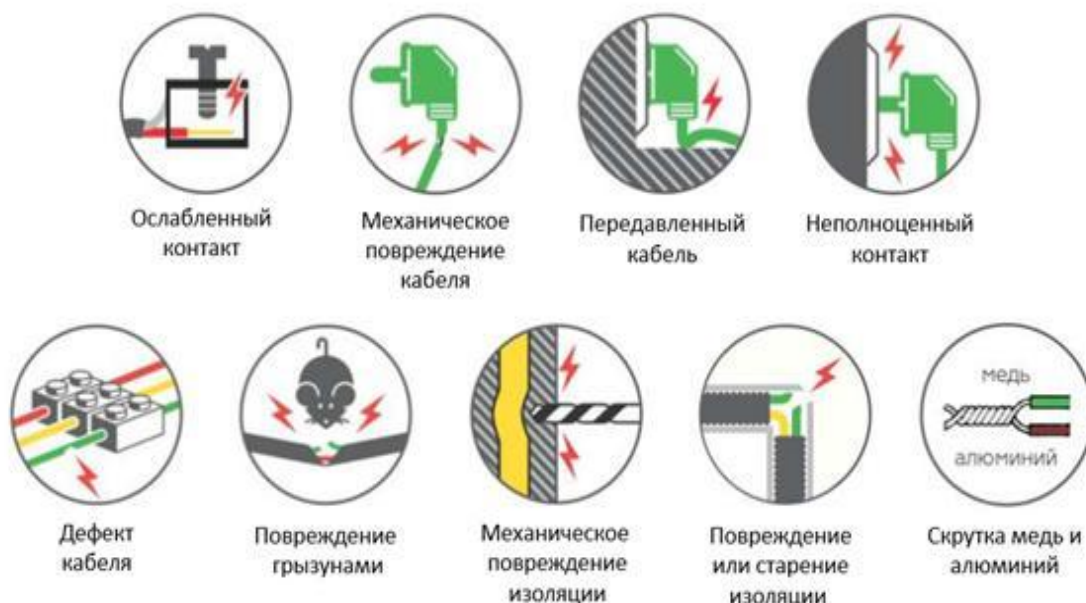
Рисунок 6. Возможные причины искрения в электропроводке
